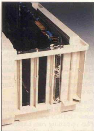
Eine EGA-Karte, wie sie hier aus dem Erweiterungsspalt lugt, läßt sich leider nur sehr eingeschränkt nutzen. Ärgerlich, aber nicht so tragisch: gut ummantelte Stecker können mit den breiten Kunststoffstegen kollidieren.
